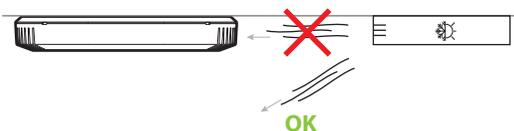
Evitare il flusso d'aria diretto sulle bocchette del prodotto. Posizionare il rilevatore a una distanza superiore a 1,5 m da una superficie vetrata per evitare la riflessione degli infrarossi.
